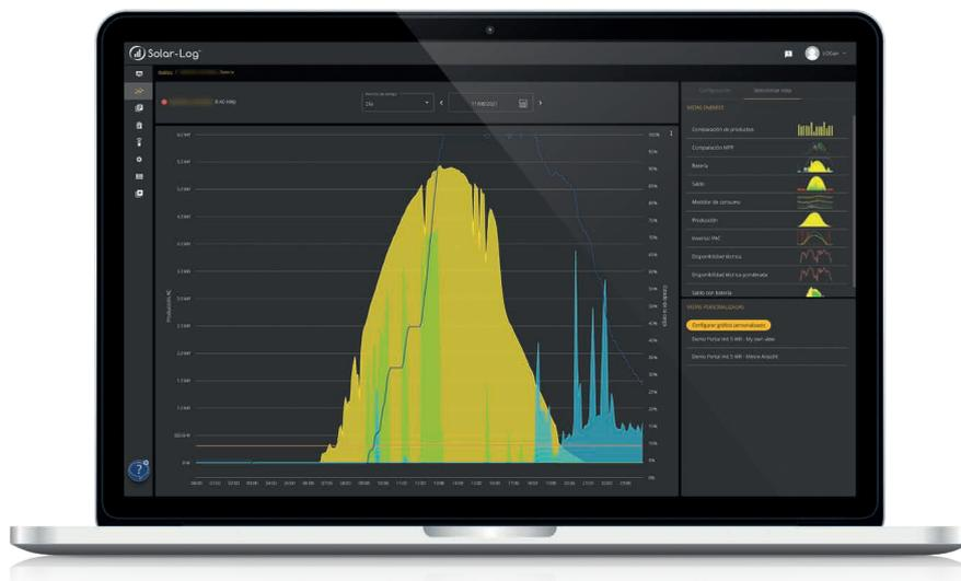
Vista diaria: El acumulador solar se carga con el excedente de energía de la instalación fotovoltaica (violeta) y se descarga de nuevo cuando es necesario (azul claro) para evitar el consumo desde la red.
