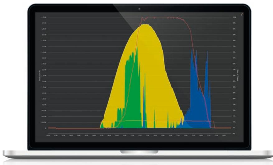
Aperçu journalier : La batterie de stockage est chargée avec le surplus de production de l'installation photovoltaïque (mauve) et déchargée en cas de besoin (bleu ciel) pour éviter le soutirage sur le réseau.
