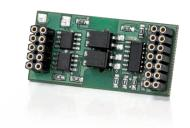
Il PiggyBack Special viene utilizzato per tutti gli inverter SMA, a meno che non sia richesto un Datamodul, un Quick Modul o uno Speedwire\*. Per ulteriori informazioni si consiglia di consultare il manuale del produttore dell'inverter. Il montaggio dell'interfaccia va eseguito esclusivamente da personale qualificato. Solare Datensysteme GmbH non si assume alcuna responsabilità per danni derivanti dal collegamento dell'accessorio.
