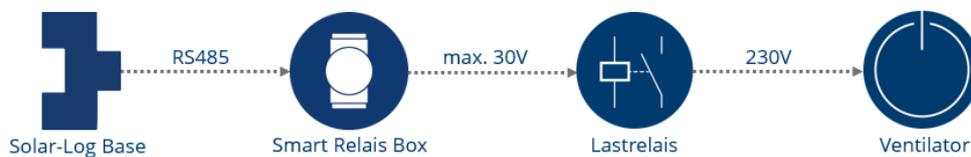
Schematische Darstellung der Ventilatorsteuerung (Stromlaufplan siehe Anhang).
