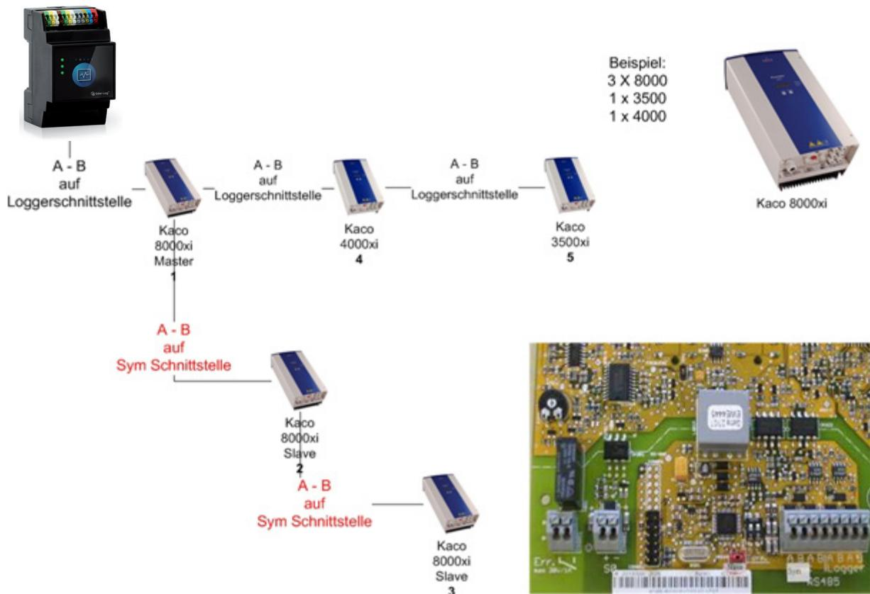
Abb.: Kaco Powador-Wechselrichter im Verbund
