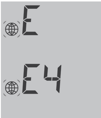
Fig.: Ejemplo de códigos intermitentes para Internet - Error 4
