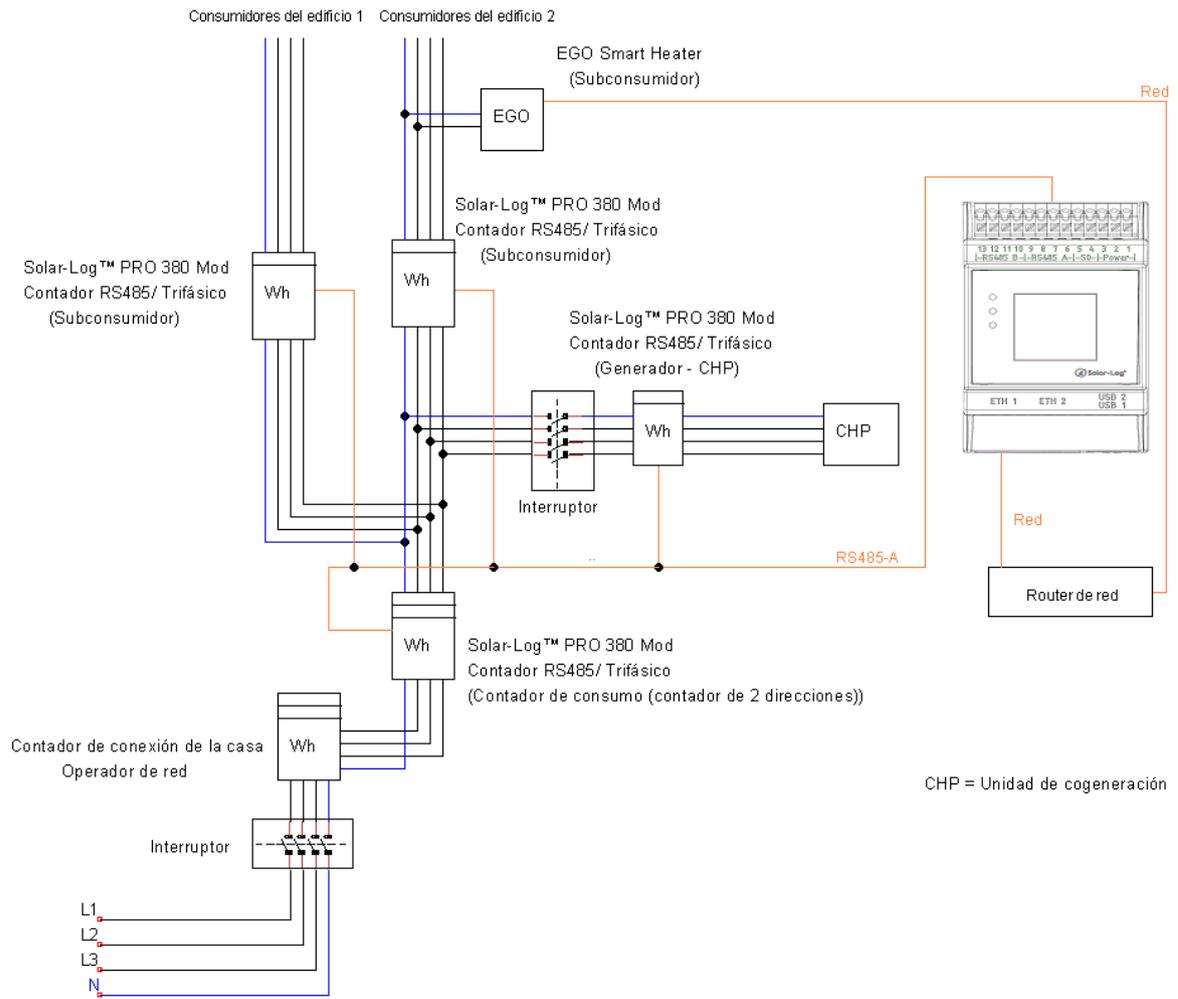
Fig.: Contador de consumo bidireccional con CHP y varios subconsumidores.
