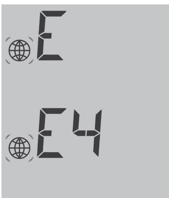
Fig.: Esempio codici lampeggianti per Internet - Errore 4
