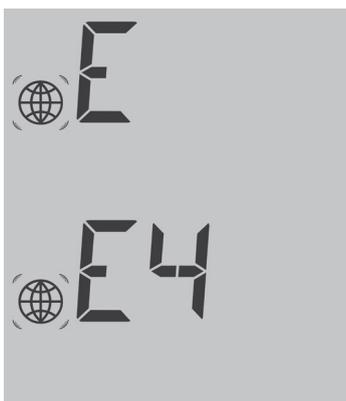
Fig.: Esempio codici lampeggianti per Internet - Errore 4
