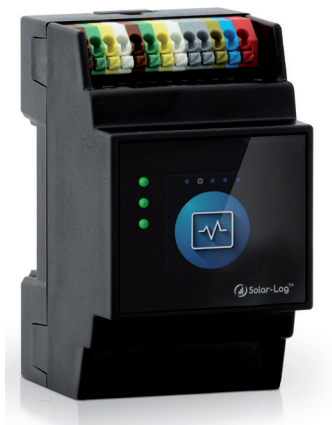
Fig.: Solar-Log Base senza naselli estratti.
