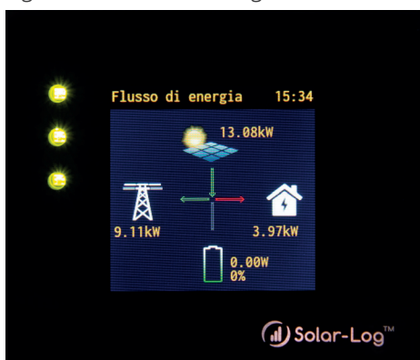
Fig.: Esempio impianto con flusso di energia
